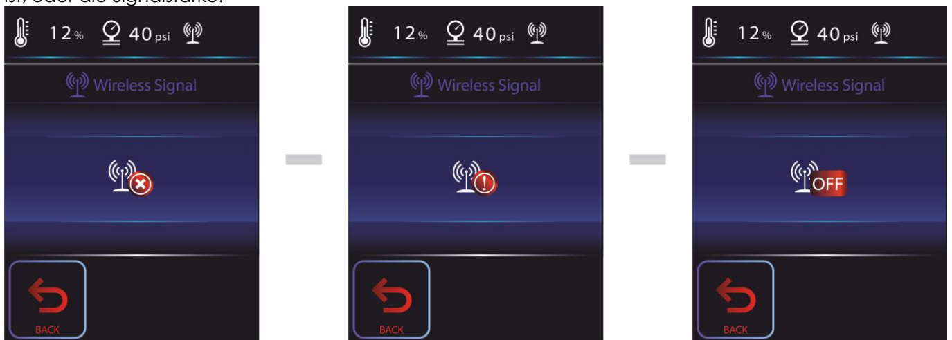
Probleme mit dem WLAN-Signal: WDMX nicht zugewiesen, kein WDMX-Signal oder WDMX-Verbindung verloren (von links nach rechts)
